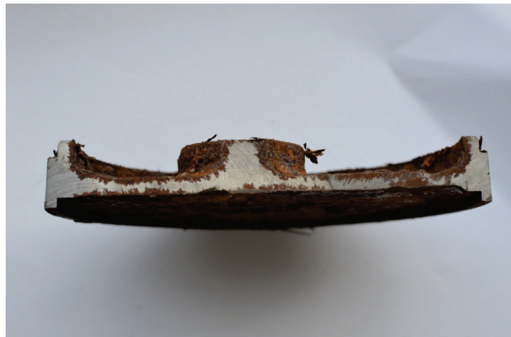
Рис. 1. Корозійні пошкодження робочого елемента вакуумного насоса
